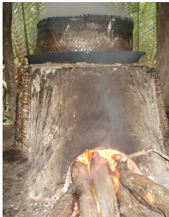
ภาพที่ 4 การเคี้ยวน้ำตาลจากโดยใช้เตาดินเหนียวแบบดั้งเดิมและใช้ “มอ” กันการกระเด็น
