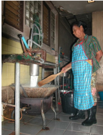
ภาพที่ 4 การทำเส้นขนมจีนด้วยกระบอกรีดเส้นขนมจีนที่พัฒนาใช้ระบบไฮดรอลิกแทนแรงงานคน
