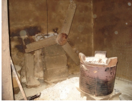
ภาพที่ 2 ห้องอบแห้งที่นายเยี่ยม เทียนเฮงพัฒนาขึ้นเพื่อใช้อบแป้ง
