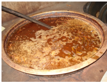
หม้อต้มเพื่อเตรียมสีธรรมชาติสำหรับการย้อม
